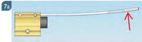
Unebenheiten von Wand oder Decke können dazu führen, dass die Zunge des Endstoppers leicht an dem Laufwagen streift. In diesem Fall entnehmen Sie den Stopper aus der Laufschiene, biegen den Fanghaken laut der obigen Zeichnung leicht nach hinten zur Laufschiene und montieren danach den Stopper wieder.
