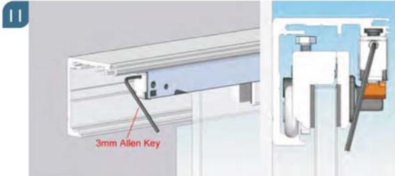
Beim Einsatz des Öldruckdämpfers ist eine Verstellung der Einzugskraft möglich. Im Auslieferungszustand ist der Dämpfer für den Einsatz einer 40 kg Türe eingestellt. Durch drehen der Einstellschraube im Uhrzeigersinn kann der Dämpfer auf 60 kg (15 Umdrehungen) oder 80 kg (30 Umdrehungen) eingestellt werden. Die Einstellung kann auch vor der Montage in die Laufschiene vorgenommen werden.
