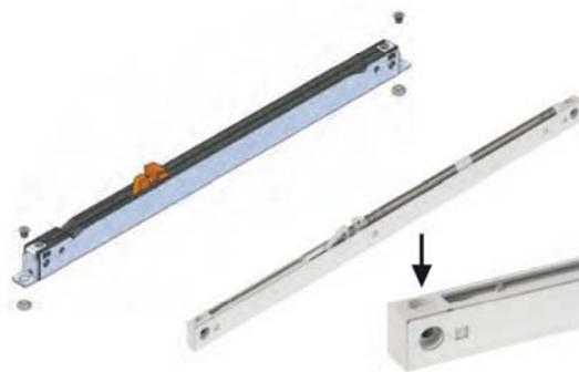
Bitte beachten Sie das wir zwei verschiedene Varianten an Selbstzieugen haben. Der Oldruckdämpfer (obere Abbildung) wird wie gezeigt mittels der M4 x 5 Schraube an das Profil befestigt. Benutzen Sie für den Luftdruck-Dämpfer (untere Abbildung) die mitgelieferte längere M4 x 19 Schraube. Diese wird durch den Dämpfer mit der beiliegenden Mutter an das Profil befestigt.
