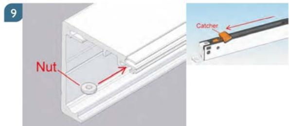
Platzieren Sie die Gewindenocken zur Montage des Selbstzieuges in der Nut der Laufschiene. Der Fanghaken (Catcher) des Selbstzieuges sollte vor der Montage in die Fangposition (siehe rechte Zeichnung) gebracht werden.
