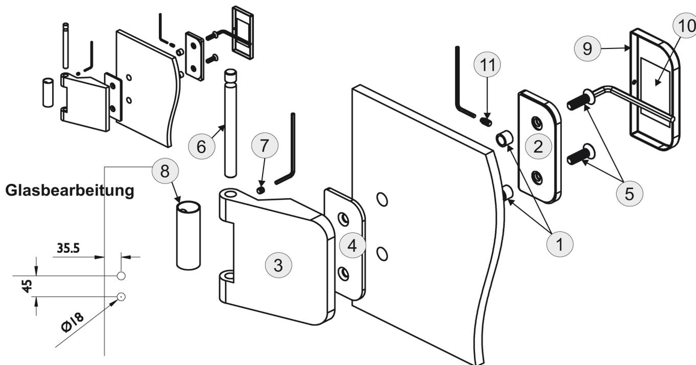
Vor der Montage der Glastürbänder muss das Glas gründlich gereinigt und Fett, Ölfrei und trocken sein. Die Glastürbohrungen sind nach dem oben abgebildeten Bohrschema vorzunehmen. Der Lochdurchmesser sollte max. 18 mm betragen.
